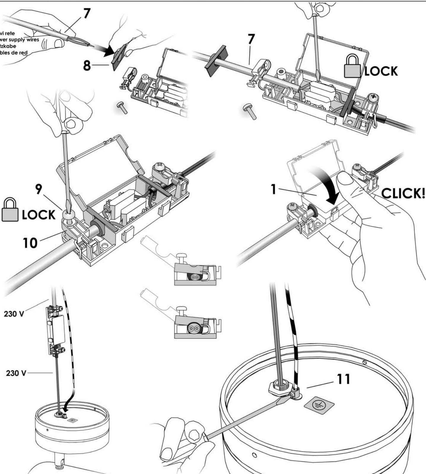
Mit einem Schraubenzieher muss man sich auf die Schließungspunkte stützen, um der Deckel der Klemme 1 zu öffnen.
