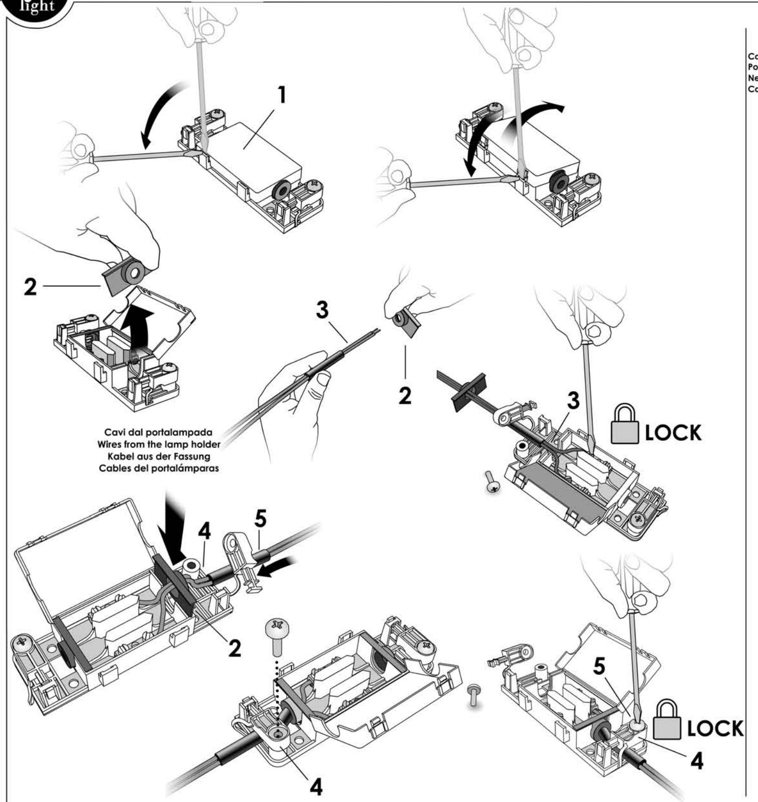
Aprire il coperchio del morsetto 1 facendo leva con un cacciavite nei punti di chiusura.
