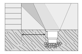
2. Eine 30cm tiefe Drainage aus Kies vorsehen. Leuchte lose im Kiesbett positionieren. Oberen Rand der Leuchte bündig OKFF ausrichten. Den Anschluss der Zuleitung nicht unmittelbar neben dem Leuchtengehäuse vornehmen, sondern im Abstand von mindestens 1 m. Mitgeliefertes Installationsrohr zum Schutz vor Beschädigungen über die Anschlussleitung bis Wasserstopper schieben.
