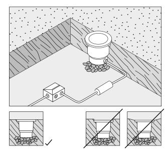
3. Optional ermöglicht der Abzweigkasten (Art.-Nr. 55380) den Anschluss im Erdreich von bis zu 6 Leuchten an die bauseitig verlegte Zuleitung. Alle elektrischen Leitungen werden nach der Installation in dem Abzweigkasten mit dem mitgelieferten Giesharz verschlossen.
